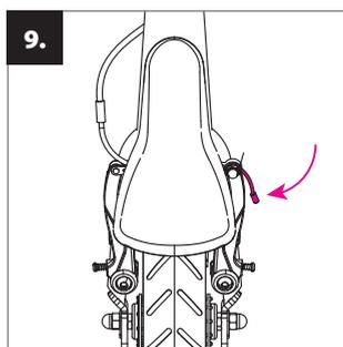
Fine del cavo del freno piegate in modo che non ostacoli la corsa del bambino.
