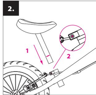
**Instalar el sillín:** inserte el tubo del sillín en el cuadro de la bicicleta (1), seleccione la altura deseada (hasta la línea marcada) y ajuste el tornillo de la abrazadera (2).
