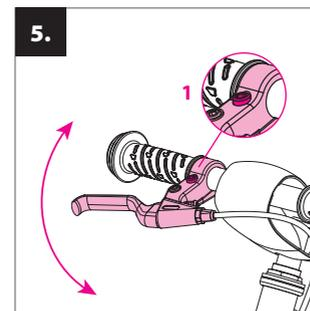
**Regolazione delle leve dei freni:** Impostate le leve dei freni in pendenza corretta utilizzando le levette di fissaggio sul maniccotto (1).
