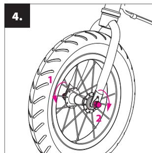
Inserire la ruota nella forcella in modo che sia esattamente al centro e stringete i dadi (1, 2) (Per facilitare l'installazione capovolgete la bicicletta senza pedali).
