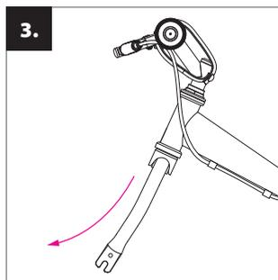
**Installazione della ruota anteriore:** Verificate se la forcella anteriore della bicicletta senza pedali è girata nella direzione giusta (curvamento leggero in avanti).
