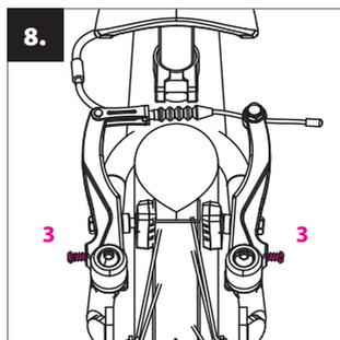
Si, lorsque vous tournez, le vélo effleure à un endroit les blocs de frein, modifiez symétriquement l'éloignement des plongeurs à l'aide des boulons-tenseurs **(3)**.
