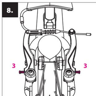
Jeżeli koło podczas obracania się dotyka w niektórych miejscach klocka hamulcowego, należy symetrycznie dostosować odległość ramion hamulca za pomocą śrubek do napinania (3).
