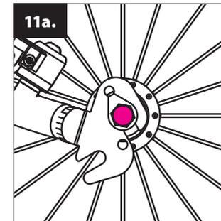
Yedoo **TOO TOO ALU** tiene una horquilla trasera doble que permite un más amplio rango de ajuste de la altura del sillín. El gancho superior sirve para poder colocar el asiento a menor altura.
