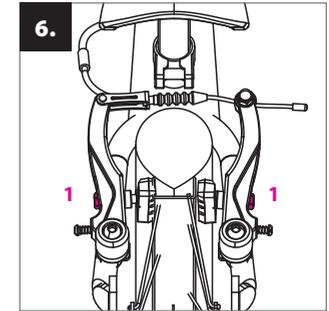
**Ajuste de los frenos:** Antes de ajustar los frenos, infle los neumáticos de acuerdo con los valores en el lateral de la cubierta (idealmente, entre 1,3 y 1,8 bar). Compruebe que al frenar, toda la superficie de las zapatas se apoye en el lado de la llanta. Su posición puede ajustarse con los tornillos (1). Las zapatas no deben tocar la cubierta.
