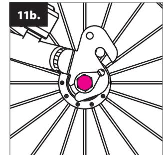
Por el contrario, el gancho inferior permite colocar el asiento a una altura superior a la normal. Precaución: luego de cada cambio de posición, vuelva a ajustar la rueda trasera.
