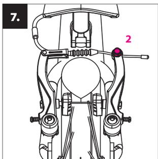
Sprawdź, czy po zwolnieniu dźwigni hamulca klocki wystarczająco odsunęły się od obręczy (1 - 2 mm). Odległość klocków można dostosować poprzez dociągnięcie lub poluzowanie linki hamulcowej w śrubie mocującej (2).
