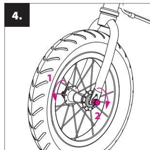
Poté do vidlice vsadte kolo tak, aby bylo přesně uprostřed a dotáhněte matici (1, 2). (Pro usnadnění montáže můžete odrážedlo překloupat do polohy vzhůru nohama).
