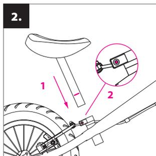
**Installazione del sellino:** inserite il tubo del sellino nel telaio della bicicletta senza pedali (1), impostate l'altezza desiderata del sellino (al massimo della linea segnata) e serrate la vite sul maniccotto (2).
