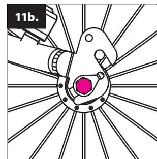
Det nedre hjulfestet gjør det mulig å plassere setet høyere enn normalt. Advarsel: Etter at man endrer posisjon må bremsene justeres.
