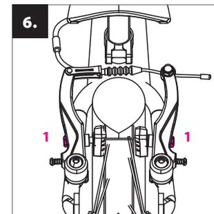
**Justering av bromsen:** före du börjar justera, pumpa upp däck enligt info på däcksidorna (rekommenderas mellan 1,3 och 1,8 bar). När du bromsar, kontrollera att bromsbeläggen trycks tätt mot fälgsidorna. Positionen kan justeras med hjälp av skruvarna (1). Beläggen ska inte vidröra däck.
