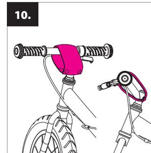
**Instalación de la almohadilla protectora:** Abroche la almohadilla protectora de nylon lavable a la barra transversal del manillar.
