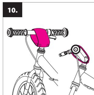
**A védőburkolat felszerelése:** helyezze fel a mosható nylonból készült puha védőburkolatot a kormányzárra!
