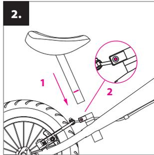
**Zadel montage:** stop de zadelpen in het frame (1) van de loopfiets, stel de juiste hoogte af (let op, niet de maximum hoogte overschrijden) en draai de sluitbout goed aan (2).
