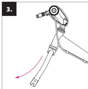
**Montaż przedniego koła:** należy sprawdzić, czy przedni widelec rowerka biegowego jest obrócony we właściwym kierunku (lekkie wygięcie jest skierowane do przodu).
