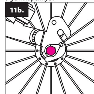
Ezzel ellentétben az alsó rögzítés lehetővé teszi a nyereg szokásosnál magasabb beállítását. Figyelem: a hátsó kerék helyzetének minden változása után újra állítsa be a fékeket!
