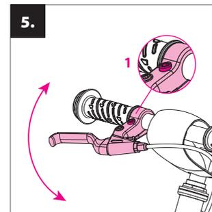
**Nastavitev zavornih ročic:** pravi naklon zavornih ročic nastavite s pomočjo pritrdilnega vijaka na objemki (**1**).
