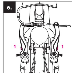
**Nastavenie brzd:** pred nastavením brzd nahustite pneumatiky na hodnoty uvedené na boku plášťa (ideálne medzi 1,3 – 1,8 baru), skontrolujte, či brzdové doštičky dosadajú na ráfik celou svojou plochou. Ich polohu môžete upraviť pomocou skrutiek (**1**). Brzdové doštičky sa nesmú dotýkať plášťa!
