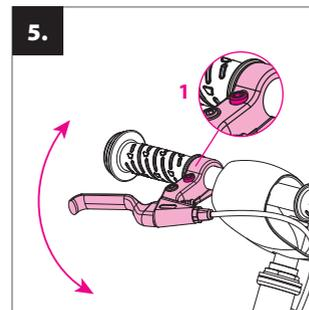
**Justera bromshandtagen:** Lossa skruven på hylsan (1) luta handtagen till rätt position, skruva sedan fast skruven på hylsan.
