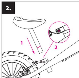
**Instalacja siodełka:** wsuń sztycę podsiodłową do ramy rowerka biegowego (1), ustaw żądaną wysokość siodełka (maks. do zaznaczonej linii) i dokręć śrubę na obejmie (2).
