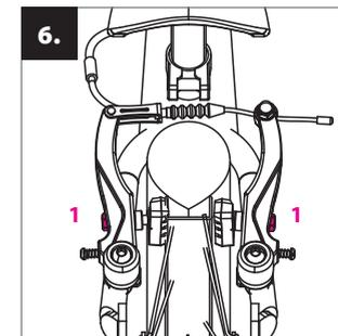
**Einstellung der Bremse:** Vor dem Einstellen der Bremsen pumpen Sie die Reifen mit dem vorgeschriebenen Luftdruck – gemäß Aufdruck an der Reifenwand – (Idealbereich: 1,3 bis 1,8 bar) auf. Überprüfen Sie auf beiden Rädern, dass die Bremsbeläge beim Bremsen mit ihrer ganzen Fläche auf der Seitenwand der Felge aufliegen. Falls nicht, lösen Sie die Feststellschraube der Bremsklötze und positionieren diese. Nach dem Festziehen der Schraube sind die Bremsklötze zu den Armen
