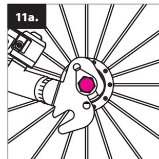
Заднее колесо беговела Yedoo **TOO TOO ALU** может быть установлено в двух положениях (2 крючка на раме сзади), это позволяет расширить диапазон высоты сиденья. Установка колеса в верхнем положении предназначено для низкого положения сиденья.
